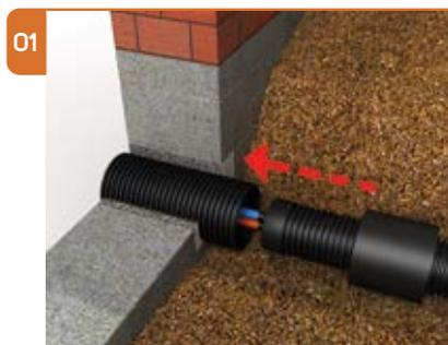
01 Гофрированная проходная гильза должна быть зацементирована в проеме стены (с помощью гидрофобного раствора, в комплект не входит) и должна выступать наружу на расстоянии 10 см от поверхности стены. Термоусадочный рукав оденьте предварительно на кожух трубопровода, без каких-либо разрезв.
