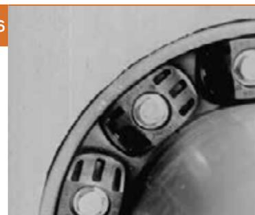
Не затягивайте болты более чем на 4 оборота за раз. Продолжайте движение по часовой стрелке. Сделайте еще 2 или 3 прохода с 3 оборотами на болт, пока звенья не будут равномерно сжаты и не будет достигнут макс. крутящий момент (см. таблицу).
