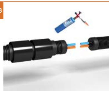
Установите термоусадочные колпачки, плавно нагревая их. Обожмите термоусадочные колпачки на кожух трубопровода и вокруг напорных труб. Используйте защитные перчатки обязательно.
