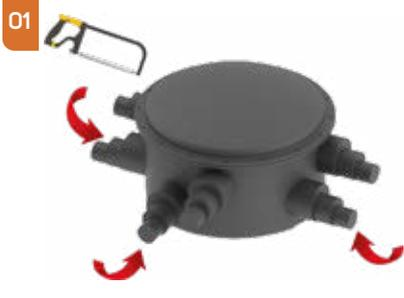
Обрежьте патрубки UIC в соответствии с необходимым диаметром кожуха трубы. Патрубок  $\varnothing$  120 для кожуха 110 мм,  $\varnothing$  170 для кожуха 140/160 мм и  $\varnothing$  235 для кожуха 75/90/200/225 мм. Для кожуха  $\varnothing$  75 и 90 мм используйте адаптеры RAS200/75 и RAS200/90.
