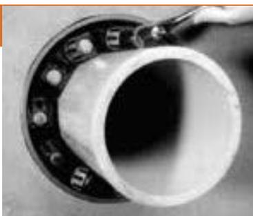
Начните с положения на «12 часов». Поочередно затягивайте все болты по часовой стрелке. Затягивайте только вручную. Не затягивайте крест-накрест. Продолжайте затягивать для равномерного сжатия.
