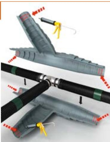
Нанесите две полосы прилагаемого герметика минимальной толщиной 5 мм и шириной не менее 4 мм на всех концах оболочки.
