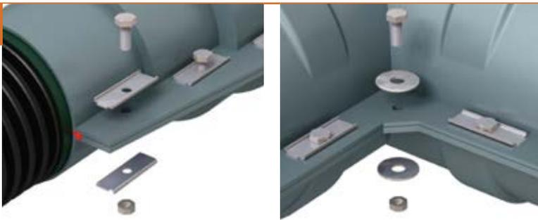
Используйте пластины и болты из нержавеющей стали для стягивания корпуса изоляционного комплекта. Во внутреннем углу используйте шайбы вместо металлических пластин.
