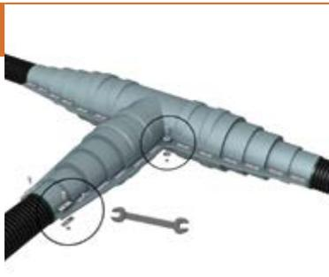
Соедините обе половины оболочки с помощью прилагаемых болтов из нержавеющей стали. Все болты следует затягивать до тех пор, пока герметик не выдавится с торцов кожуха.
