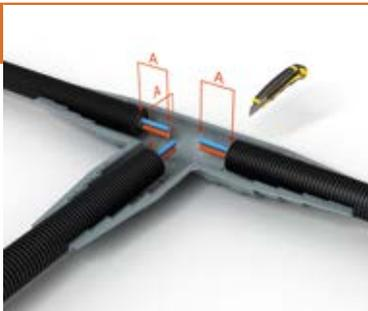
Осторожно удалите оболочку трубопровода и слои изоляции, чтобы не повредить напорные трубы внутри. Длина напорных труб обозначена значком А. Длина зависит от диаметра напорных труб:
