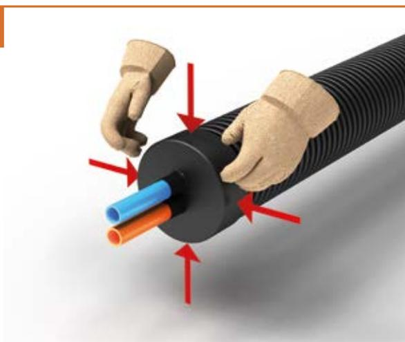
В защитных перчатках обожмите термоусадочный колпачок на напорные трубы и наружный кожух.
