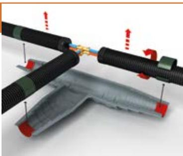
Идеально подгоните битумную ленту к наружному кожуху на концах Т-образных изоляционных оболочек без нахлеста и обрежьте битумную ленту.
