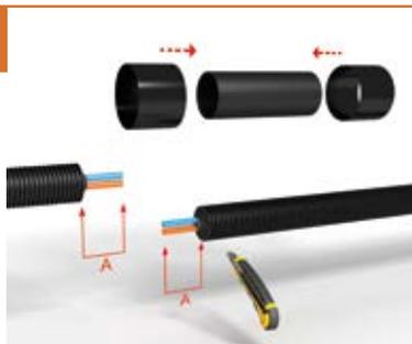
Осторожно удалите оболочку трубопровода и слои изоляции, чтобы не повредить напорные трубы внутри. Длина напорных труб обозначена значком А. Длина зависит от диаметра напорных труб:
