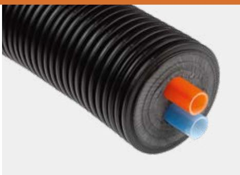
Многослойная теплоизоляция изготовлена из свитого микропористого пенополиэтилена PE-X с водоотталкивающей закрытой ячеистой структурой, характеризующейся прочными, стойкими к износу изоляционными характеристиками и постоянной эластичностью, обеспечивающей максимальную и неизменную толщину изоляционного слоя, даже после многократного сгибания.
